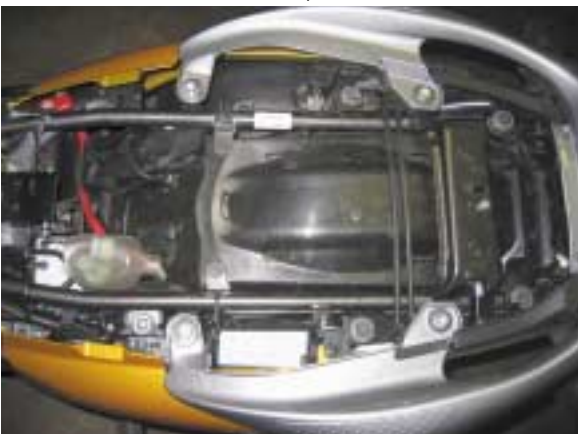
Batterie et fusibles tombent sous la main après déblocage de la selle avec la clef de contact.
