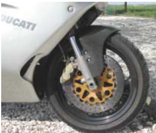
◀ Disques de frein avant flottants en fonte.
