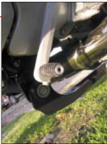
Ergonomie toujours avec les embouts de sélecteur et de pédale de frein montés sur excentriques, ce qui permet d'en régler simplement et de manière optimale la hauteur et la longueur.
