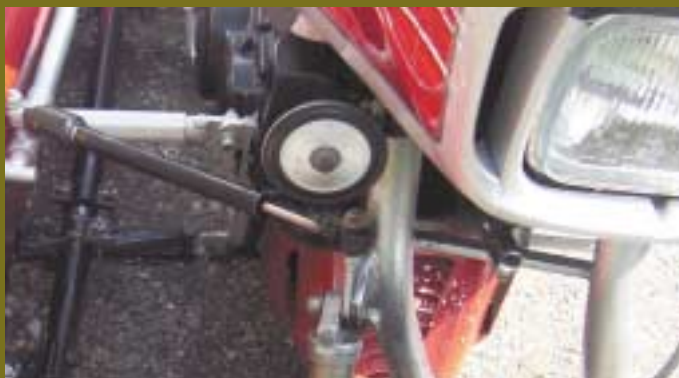
Détail de l'attache remorque (boulon en départ ici, deux séries de brides et enfin deux tubes de renfort qui prennent sur les fixations côté moto et côté side.
