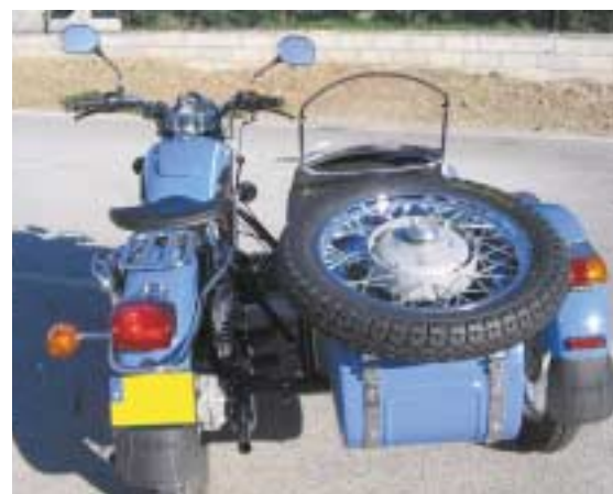
La roue de secours peut être montée sur le panier ou à l'arrière de la moto, mais pas sur l'avant lorsque la moto est équipée du frein avant à disque.
