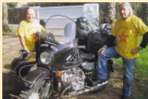
De retour du raid et de gauche à droite : Paulo et Mija. Préparation de l'attelage : 3 pneus à crampons type Rangers, 2 réservoirs d'appoint pour un bon 600 km d'autonomie... Et roule ma poule !
