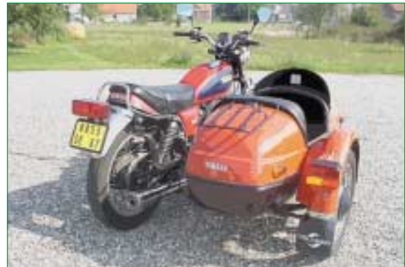
Vue arrière de l'ensemble. À noter le porte bagage et siège basculant pour accéder au coffre.
