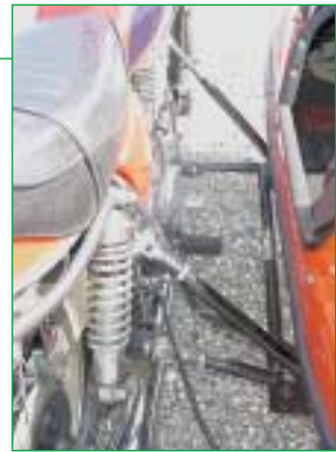
L'amortisseur du side d'origine Jawa est une catastrophe et l'échange contre un Koni s'impose après avoir modifié le bras oscillant.
