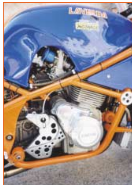
Moteur 120° réalisé en 1200 cm 3 (pistons de Ø 81 mm).
