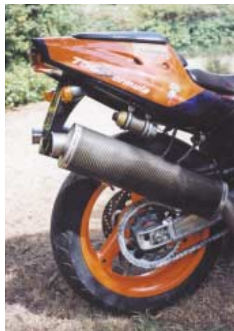
Plan arrière droit. Les échappements carbone d'origine sont de splendides Termignoni, homologués.
