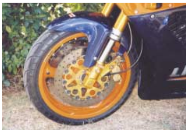
D'origine, les accessoires sont de très haut de gamme : jantes Marchesini, freins Brembo flottants de 320 mm pour l'avant, et de 245 mm pour l'arrière. Superbe fourche Paioli !
